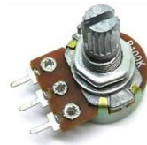
รูป 6 สัญลักษณ์ตัวต้านทานแบบปรับค่าได้ และตัวอย่างตัวต้านทานแบบปรับค่าได้
