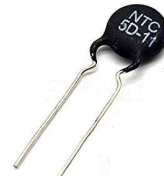
รูป 8 สัญลักษณ์ตัวต้านทานที่เปลี่ยนตามอุณหภูมิ และตัวอย่างตัวต้านทานที่เปลี่ยนตามอุณหภูมิ
